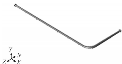
图11 +Z向地震加速度为0.3g时L形弯管结构形变图
